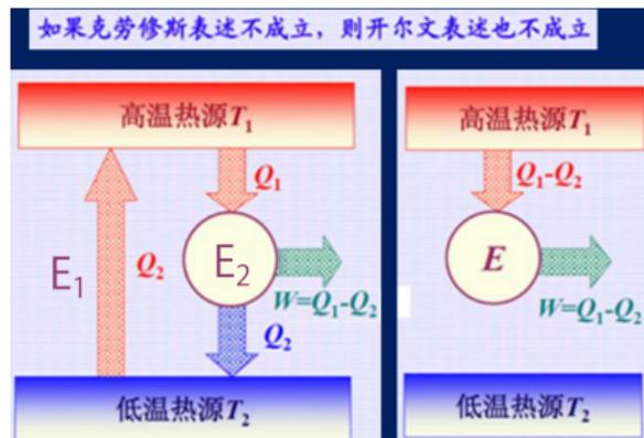
假设存在违反克劳修斯表述的制冷热机  $A$ ，存在不利用外界对其做功的情况下，是热量  $Q_2$  由低温热源  $T_2$  流向高温热源  $T_1$ 。又假设存在热机  $B$ ，可以从高温热源吸收热量  $Q_1$  并将其中的  $Q_1 - Q_2$  转化为有效功  $W$ ，同时将热量  $Q_2$  传递给  $T_2$ 。若联合  $A$  和  $B$ ，则可以看到它们组成的热机从高温热源  $T_1$  吸收热量  $Q_1 - Q_2$  并将其完全转化为有效功  $W$ ，而且不引起其它任何变化，即开尔文表述。
